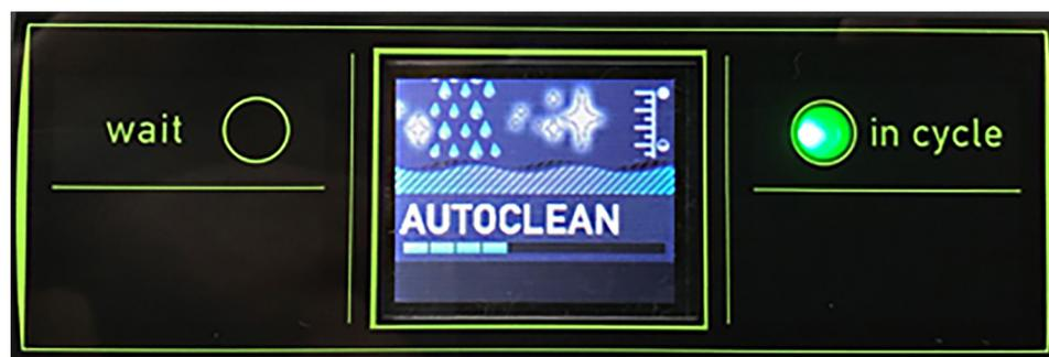
1. Lorsque le commutateur d'alimentation est placé à la position OFF, l'écran AUTOCLEAN s'affiche et montre la progression du nettoyage automatique.
